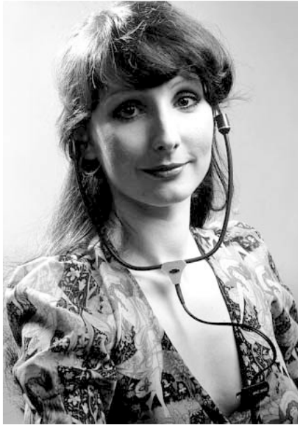
Abb. 32 Kopf-Stereomikrofon (MKE 2002, Sennheiser)
